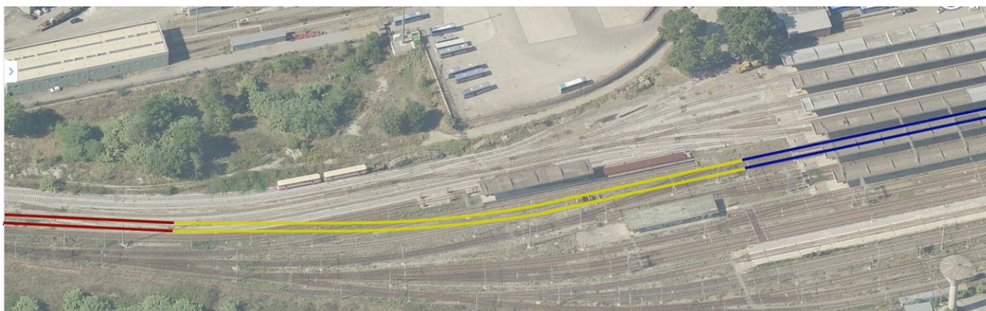
Figura 2 Vista in dettaglio dell'interconnessione. In rosso i binari FC, in blu i binari FS, in giallo i nuovi binari di collegamento.
